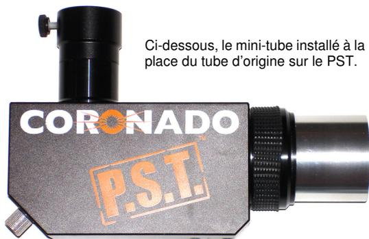
Ci-dessous, le mini-tube installé à la place du tube d'origine sur le PST.
