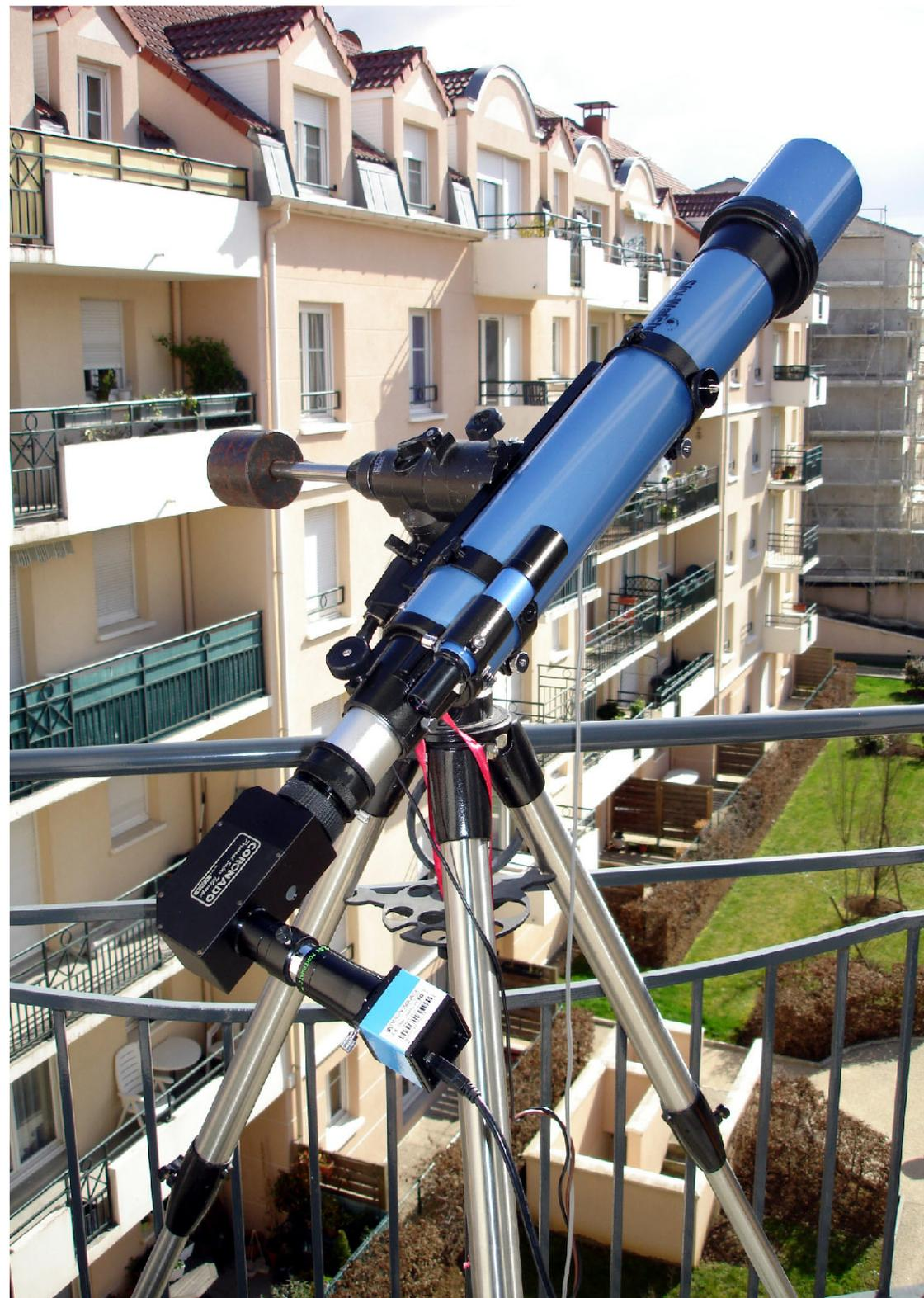
La figure 5 montre la configuration complète utilisée en imagerie. Celle-ci comprend donc la lunette SkyWatcher 102/1000 écourtée, le bloc de filtration du PST, une barlow Tele Vue Powermate 2.5x et une caméra Imaging Source DMK 31AF03.AS.
